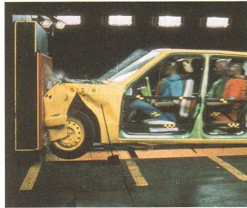
4 Verformungsarbeit bei einem Crashtest
